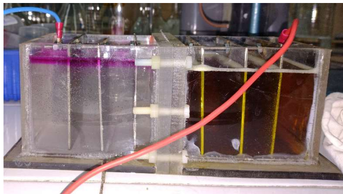
Figura 1. Celula de electrodializa cu membrana cation selectiva (Nafion 2050) – test pentru evidențierea prezenței NaOH în compartimentul catodic -se observă colorația specifică a fenolftaleinei
